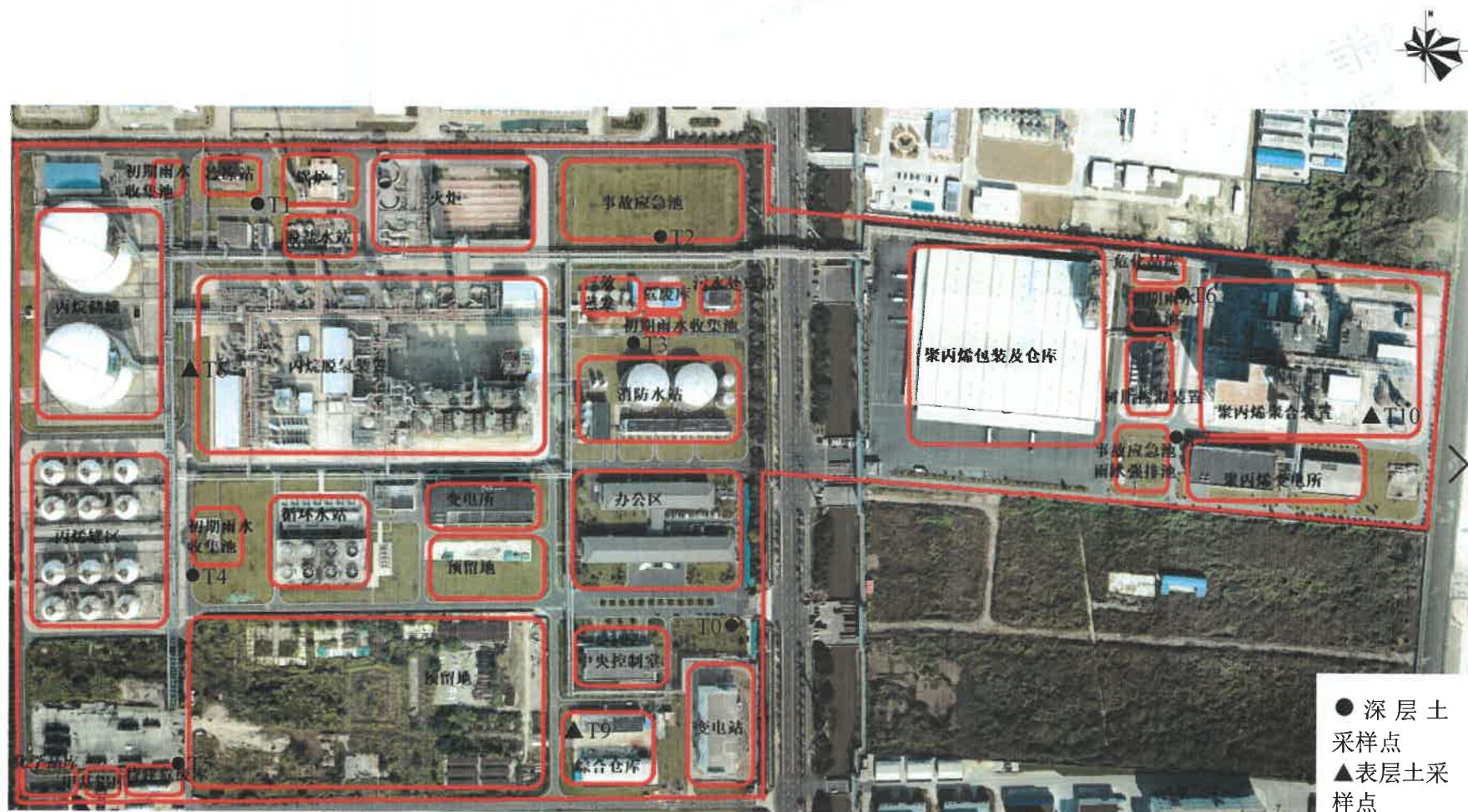
苏州华能检测技术有限公司 附图二: 土壤测点位置示意图
